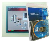
Предназначен для отображения информации и для исполнения логических программ на панелях (устройствах) под Windows CE, а также для исполнения логических программ управления. Modbus, DCON, драйверы промышленных протоколов и счетчиков электроэнергии (63-127 - один счетчик, более 127 каналов - 2 счетчика). Горячее резервирование сети и контроллеров. Программируется в инструментальной системе TRACE MODE на 5 языках стандарта МЭК 6-1131/3.
